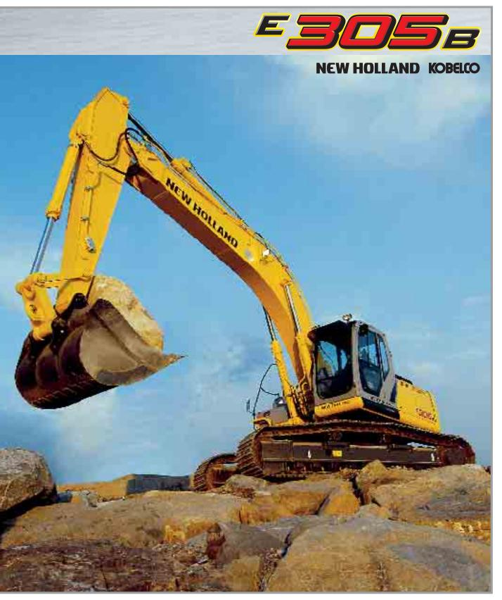
NET FLYWHEEL POWER 152 kW - 204 hp OPERATING WEIGHT (MAX) 31 620 kg
